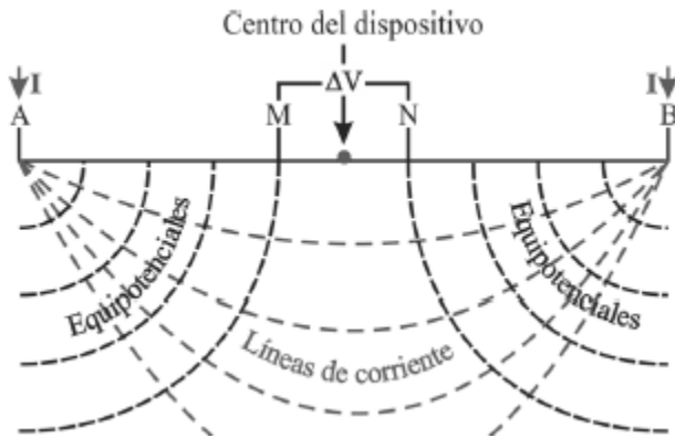
Figura 1. Diagrama Schlumberger para medición de resistividad en el campo
