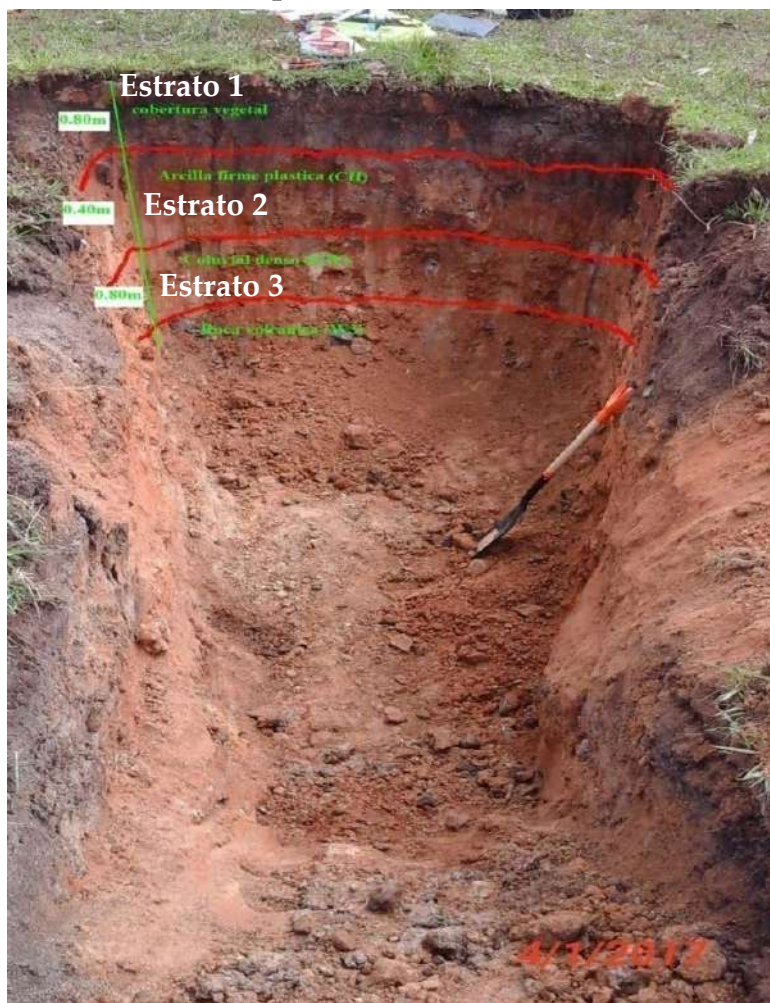
Figura 8: vista de excavación de calicata.
